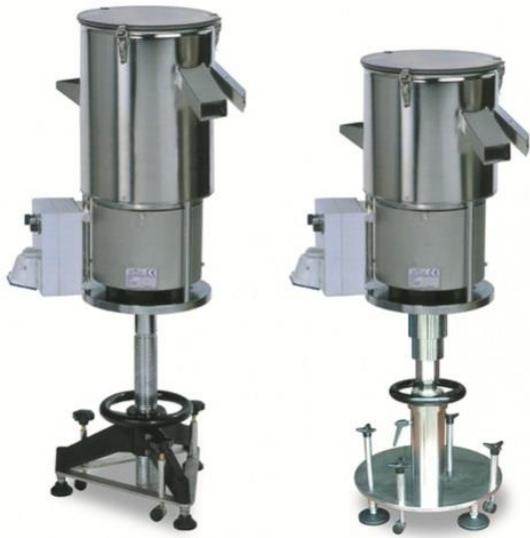
Fácil de instalar, regulable en altura. La eliminación de polvo y rebabas se produce gracias a la vibración a lo largo de un canal de 4 metros (modelo STD) o 7 mts (High versión) de recorrido de abajo hacia arriba, por un tornillo a espiral con una pista para las tabletas y una pista subyacente y separada para el polvo resultante que se puede recuperar totalmente sin requerir un sistema de aspiración. Se puede ajustar la intensidad de las vibraciones y la velocidad.
