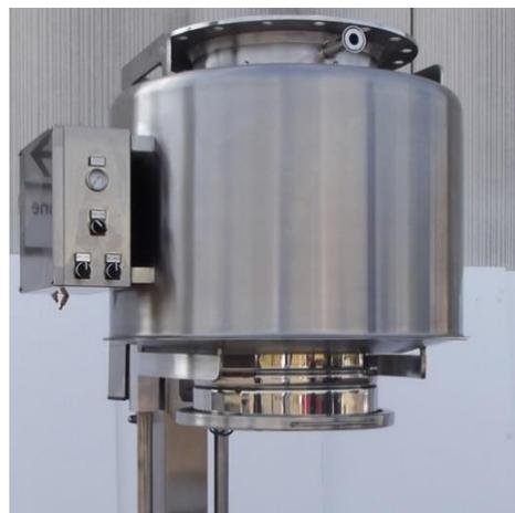
El sistema continuo de embolsado de bolsas representa una solución confiable, segura y simple para las operaciones de llenado de polvos nocivos, asegurando un alto grado de contención para proteger al operador, el medio ambiente y el producto en sí.
