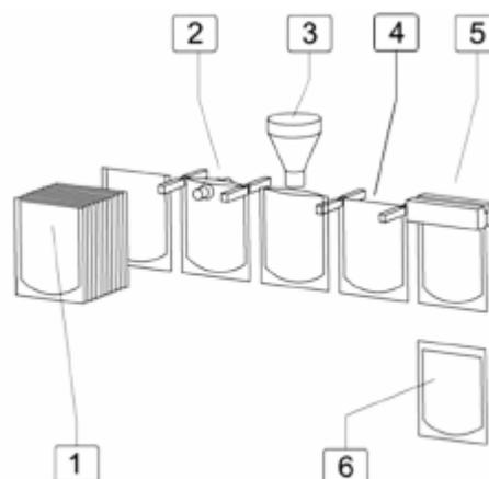
Los modelos de máquinas PRE-MADE POUCH (PMP) son máquinas automáticas de sobre pre-confeccionado. Han sido concebidas para el envasado de productos sólidos, líquidos, polvos y de alta viscosidad. Según el producto, la dosificación de la máquina puede realizarse con: - Dosificador sinfín:
