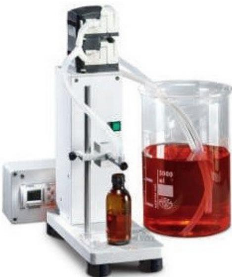
La máquina Easycream consiente la rápida y segura dosificación para el confeccionado de líquidos y productos ligeramente viscosos. El instrumento es de fácil uso, utilizando un PLC para el control de una bomba peristáltica. Mediante el interruptor de marcha se acciona la máquina que cumplirá el exacto número de giros, deteniéndose automáticamente en el valor programado. Esta solución consiente una notable precisión en la repetitividad de los dosajes.
