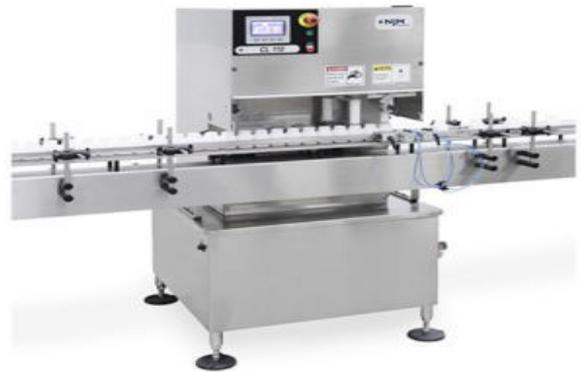
La construcción resistente y el diseño robusto caracterizan a los Cottoners de NJM Packaging. La operación es simple pero precisa, con un dispositivo de desgarro de guillotina como equipo estándar y opciones como detección de algodón y mechones faltantes.
