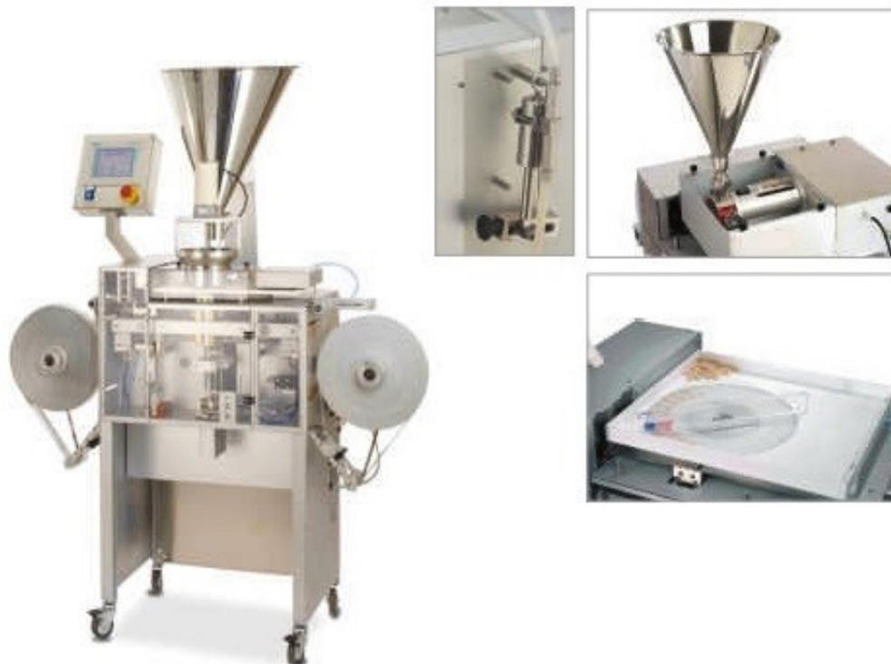
Máquina automática intermitente para la elaboración de bolsitas soldadas por los cuatro lados. El tamaño de la bolsita puede escogerse entre las siguientes anchuras: 30, 40, 50, 60, 70 y 80 mm.
