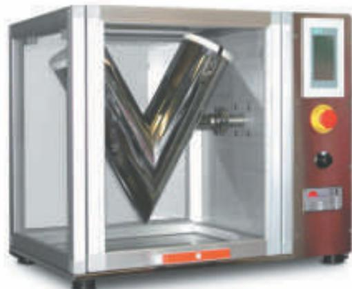
Gracias a las dos aberturas en los dos extremos de la V es posible una fácil limpieza y lavado del contenedor, dejándolo inmediatamente disponible para diversas mezclas. La máquina está equipada con un panel touch screen conectado a un PLC Siemens en el cual se pueden seleccionar los parámetros de mezcla tales como el tiempo, el intervalo de inversión del sentido de rotación y la velocidad de la rotación.
