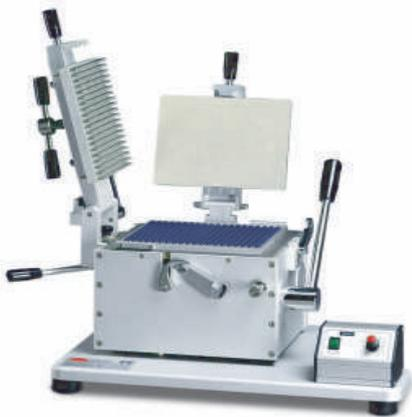
Máquina llenadora de capsulas semiautomática para la preparación simultánea de 300 cápsulas. Normalmente en combinación con el orientador MS 4/7 o MS 1, la máquina está disponible para todos los tamaños de cápsulas de gelatina dura del 000 al 5 y, con accesorios especiales, también para los tamaños DB Caps.
