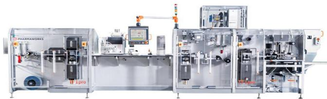
La máquina “pro” incorpora muchas innovaciones nuevas en el envasado en blíster. Con velocidades de hasta 100 índices por minuto y un rango de formación utilizable de 120 mm x 165 mm, la máquina blíster TF1pro es una plataforma versátil.
