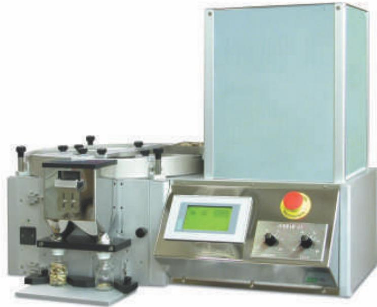
Máquina contadora electrónica apta para el recuento de las más diferentes formas farmacológicas sólidas como cápsulas, comprimidos redondos y oblongos, pastillas, softgel, etc.
