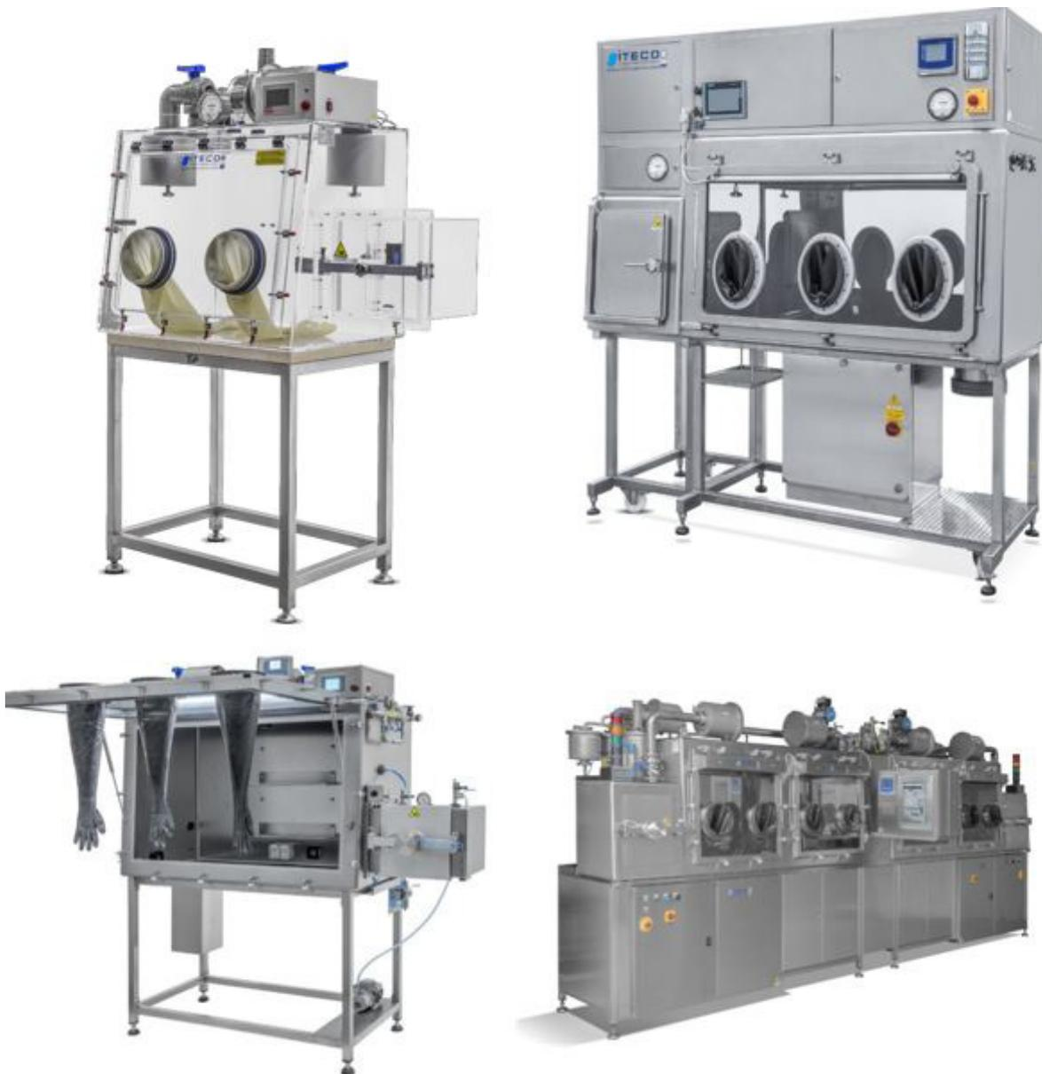
La demanda del mercado farmacéutico de productos elaborados con API y HPAPI hace necesaria la realización de sistemas de protección que permitan la manipulación de estas sustancias con total seguridad. La Línea “AMI” incluye una serie de Aisladores de alta contención. Fabricados con estructura de acero inoxidable AISI 316L y aplicados al manejo de API y HPAPI en forma sólida (hasta OEB4 y OEB5).
