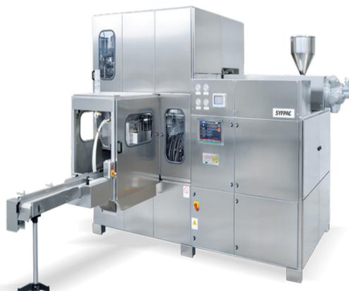
Syfpac® LVP ha sido proyectada especialmente para envases con capacidad desde 50 ml. hasta 2500 ml. para el acondicionamiento en aséptico de soluciones intravenosas, soluciones para irrigaciones, desinfectantes, jabones líquidos, soluciones para diálisis continua, dosificación oral y antibióticos.
