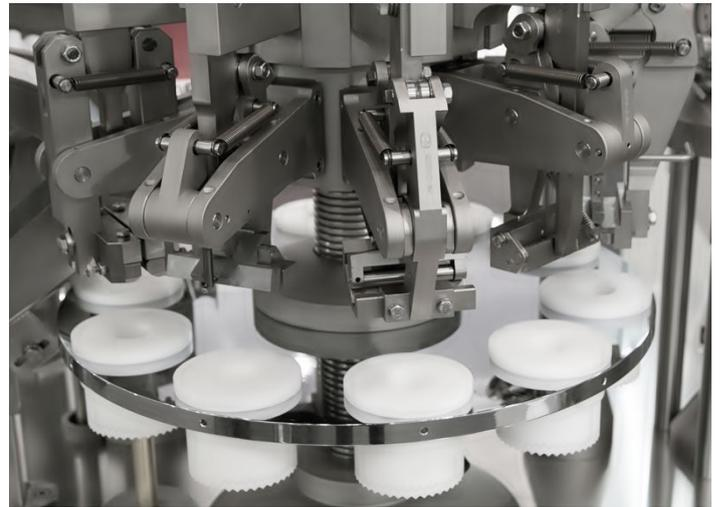
La máquina automática rotativa de llenado y sellado de tubos de alta calidad con un marco y paneles de acero inoxidable, puede equiparse para cerrar/sellar tubos de aluminio, polietileno y laminados. Ideal para instalaciones en ambientes estériles y totalmente confiable en el tiempo.
