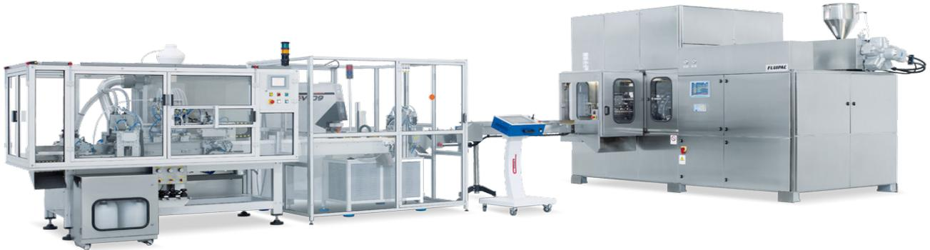
La dificultad de manipulación y envasado se ha resuelto de forma simple y elegante, y se ha obtenido un envasado automático del adhesivo de cianoacrilato con una velocidad de hasta 18.000 unidades por hora en un equipo completamente automático que produce envases a partir del polímero granulado, imprimiendo el nombre del producto y otra información sobre los envases, llenándolos y sellándolos, todo eso en una línea automática continua con una fiabilidad de más del 99,5%.
